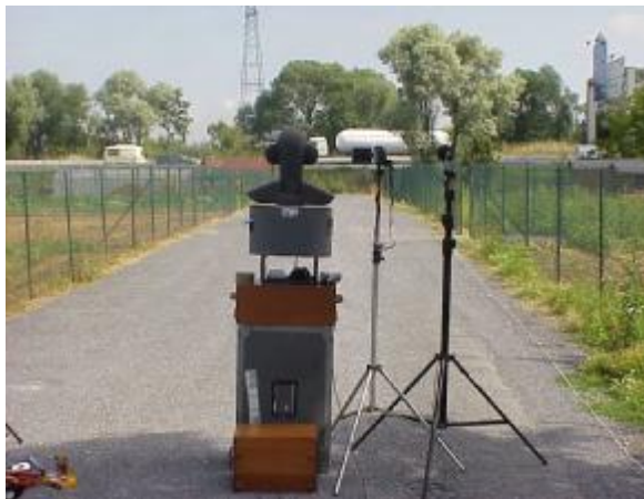
Σχήμα 1. Διωτική ηχογράφηση θορύβου αυτοκινητοδρόμου με ταυτόχρονες ακουστικές μετρήσεις και λήψη video σε σημείο που βρίσκεται σε ελεύθερο ακουστικό πεδίο.
