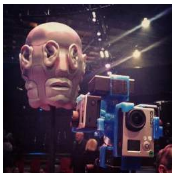
Σχήμα 3.1. 360° Σύστημα καταγραφής αμφιωτικού ήχου και κάμερας.
