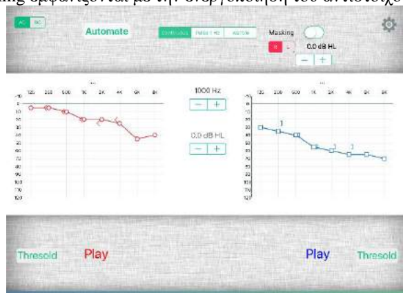
Σχήμα 2.1 Το περιβάλλον της εφαρμογής «Butterfly Hearing» κατά την διεξαγωγή τονικής ακοομετρίας
