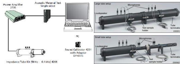
Σχήμα 2.1 Σχηματική αναπαράσταση ακουστικής εμπέδησης στάσιμων κυμάτων (Kundt) της Bruel & Kjaer, για συχνότητες 50-6400Hz.
