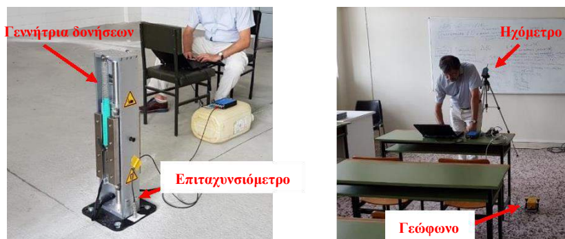
Εικόνα 1. Διάταξη μετρητικού εξοπλισμού στον χώρο εκπομπής (αριστερά) και στον χώρο λήψης (δεξιά)
