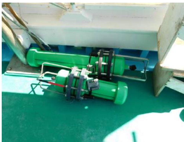
Σχήμα 3.2 Οι δύο αυτόνομες συσκευές καταγραφής υποθαλάσσιου ήχου UL1 and UL4 που αναπτύχθηκαν στο ΙΤΕ, στο κατάστρωμα του σκάφους F/V Elena πριν την πόντισή τους στη νότια ακτή της Κρήτης.
