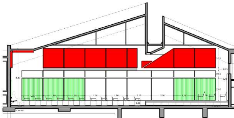
Σχήμα 2.1 Διανομή των ηχοαπορροφητικών (κόκκινο) επιφανειών και των διαχυτικών επιφανειών (πράσινο)
