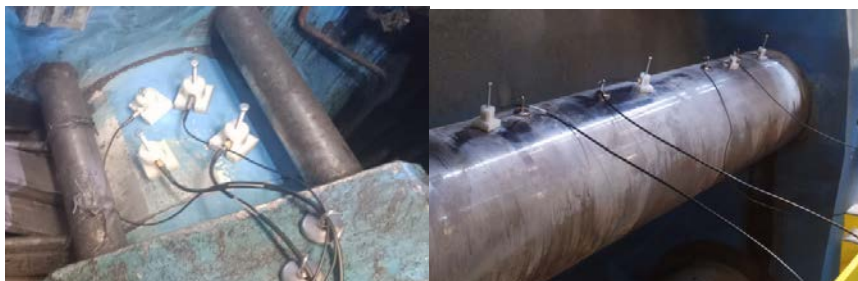
Σχήμα 1.3 Τυπική διάταξη αισθητήρων σε μπροστινό έμβολο (α) και οπίσθιο (β)
