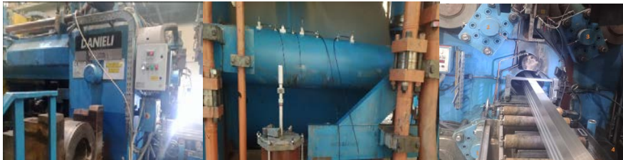
Σχήμα 1.2 Πρέσα μετρήσεων(α), οπίσθια(β) και μπροστινά έμβολα (γ)
