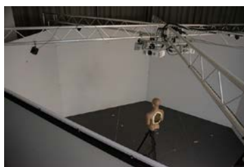
Σχήμα 3.3: Η αμφιωτική διάταξη [7] που χρησιμοποιήθηκε για τις ηχογραφήσεις
