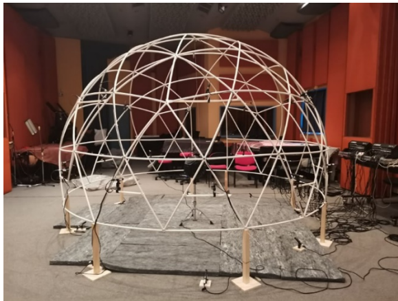
Σχήμα 1.1 Η διάταξη του ημισφαιρικού κλωβού μέσω της οποίας διενεργήθηκαν οι ηχογραφήσεις.
