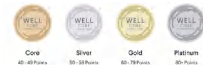
Σχήμα 2.2 Επίπεδα κατάταξης WELL
