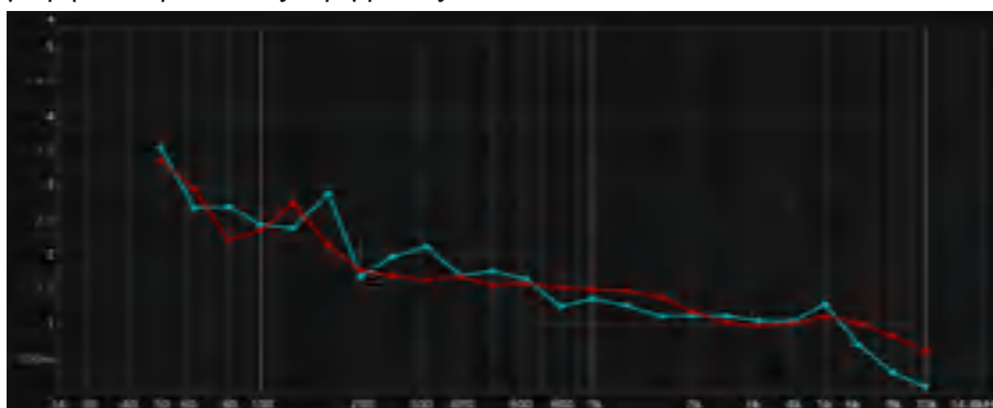
Εικόνα 1.2 Μετρήσεις RT60 της υπάρχουσας κατάστασης πριν από τις παρεμβάσεις T20 (κόκκινο) και EDT (κυανό).
