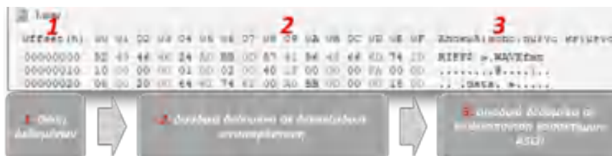
Εικόνα 2-1 Παράθυρο και πεδία βασικής διάταξης δεκαεξαδικού προβολέα [17]
