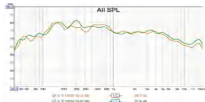
Εικόνα 3.2. Μέτρηση απόκρισης συχνοτήτων στο σε κάθε ηχείο, συστήματος Telmaco πριν την διαμόρφωση ακουστικής της αίθουσας.
