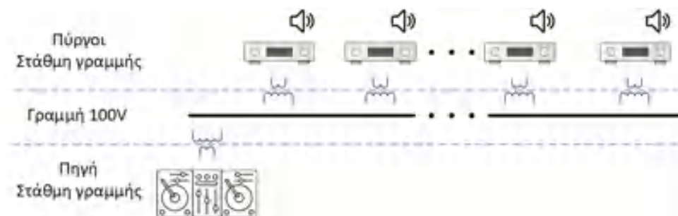
Εικόνα 1.3 Η δομή του συστήματος μετάδοσης του σήματος στα 100V.
