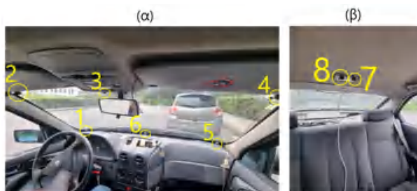
Σχήμα 1 Κατανομή των μικροφώνων μέσα στο Alfa Romeo. Η κατανομή είναι ενδεικτική και για την τοποθέτηση στα υπόλοιπα αυτοκίνητα που είχαν κατανεμημένα μικρόφωνα.
