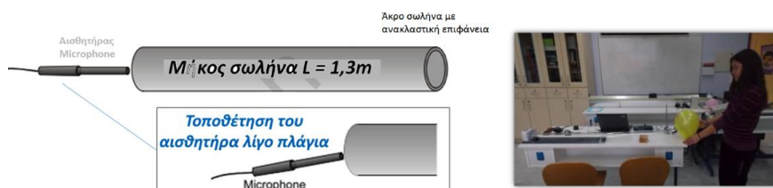
Σχήμα 3.1. Πειραματική διάταξη για τη μέτρηση της ταχύτητας του ήχου
